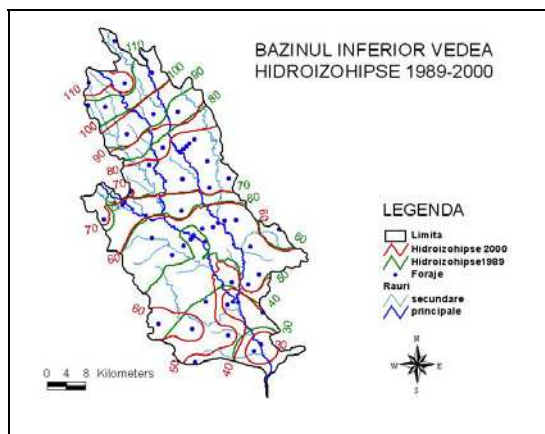
Fig.7. Hidroizohipse 1989 și 2000 hidrogeologice
