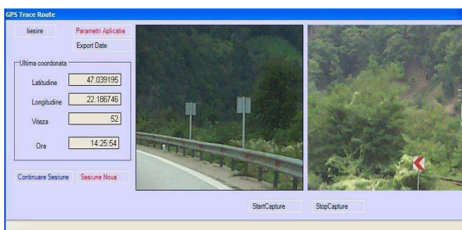
Fig. 6 Sistemul informatic de înregistrare video/GPS.
